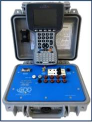
**El Receptor IP GRx8mini:** Es compacto y de bajo consumo de energía, peso ligero (3,1 kg) y ofrece una configuración multi-línea 3D (1/8 o 2/4). Puede visualizar las pseudosecciones en tiempo real como con todos los otros GDD receptores IP. Nuestros receptores están diseñados específicamente para aumentar la calidad de los datos y la productividad de estudios de resistividad y polarización inducida (IP).
